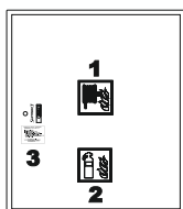
Prawidłowe oznaczenie hydrantu
