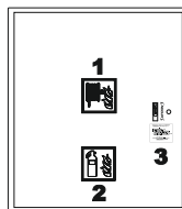
Prawidłowe oznaczenie hydrantu
