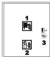
Prawidłowe oznaczenie hydrantu
