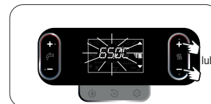
drugie naciśnięcie ustawienie wartości nastawy temperatury zasilania c.o., ze skokiem 0,5°C
